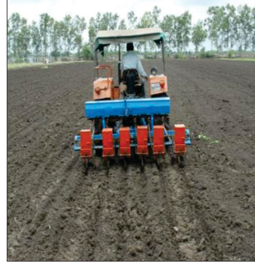
किसान के खेत में झुकी हुई प्लेट वाले रोपाई यंत्र का उपयोग
